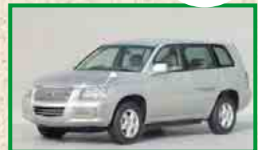
↑燃料電池で走るクルマ。作られた電気で、モーターを回す。
