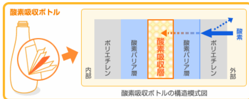
図1 酸素吸収性ポリエチレン・ブローボトルを用いた低カロリーマヨネーズ容器の構造
