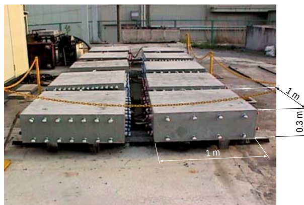
第 11 図 床版切出しモデル試験体 Fig. 11 Slab scale models for tests
