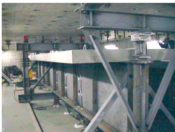
第 9 図 合成桁 1/5 模型供試体 Fig. 9 Composite girder scale model (1/5) for tests
