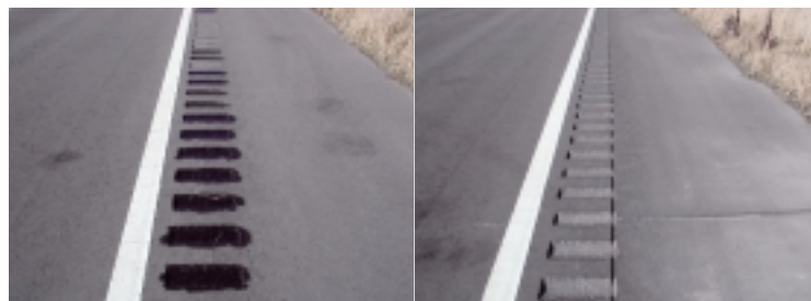
A区間 E区間 写真 - 9 凍結試験状況（2.5時間後）
