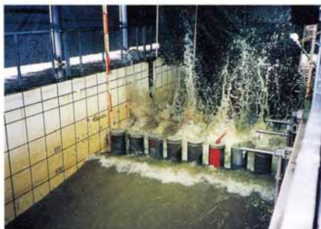
写真-1 堤体への波の作用状況（基本型）
