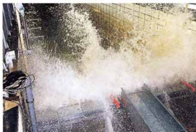
写真-3 パラベットへの波の作用状況（改良型）
