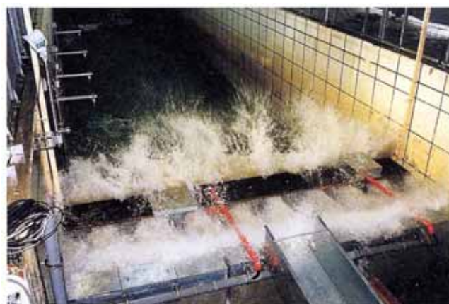
写真-2 水平板への波の作用状況（改良型）
