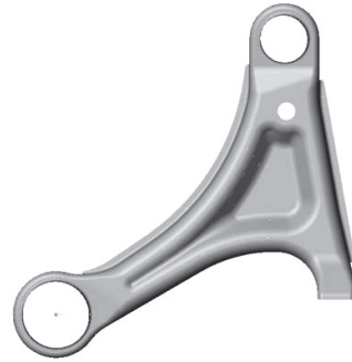
図3 開発 780 MPa 級鋼板のロアアーム適用
