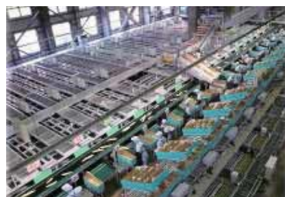
長いもの洗浄ライン（農林水産省：地域ブランド化の先進的取組事例集より）
