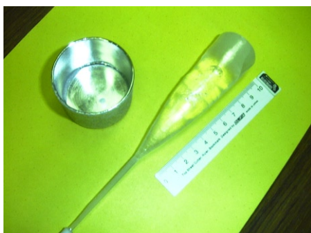
写真2 単結晶フォルステライト“Artificial Mantle Material”
