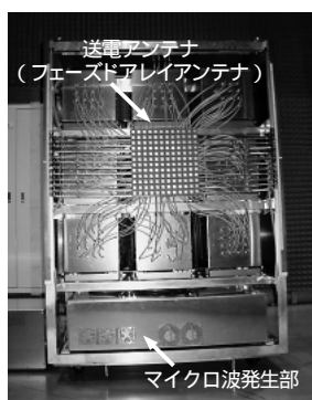
図3 ビーム形成制御サブシステム 144個の各アンテナの出力を低損失移相器で制御し、細かな送電方向制御を行う。
